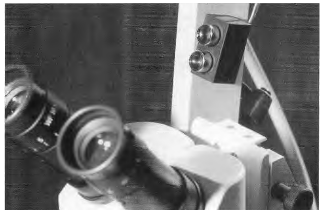
Abb. 5: InPro Op-Sensortronic zur Lichtreduzierung an Operationsmikroskopen
